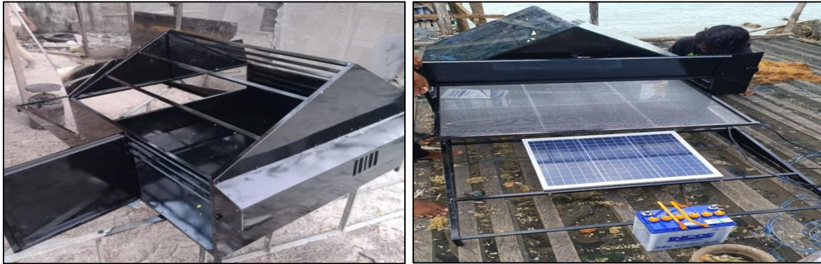
Gambar 2. Alat pengering ikan fotovoltaik tipe 2 (dua) bangki
