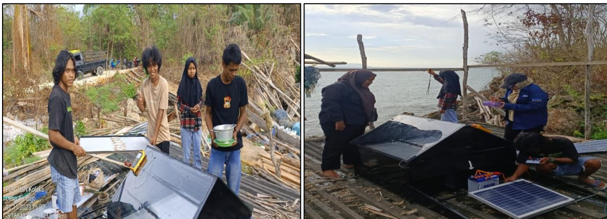
Gambar 3. (a) Proses pemasukan ikan ke dalam alat pengering; (b) Pengambilan data parameter pada alat pengering ikan fotovoltaik
