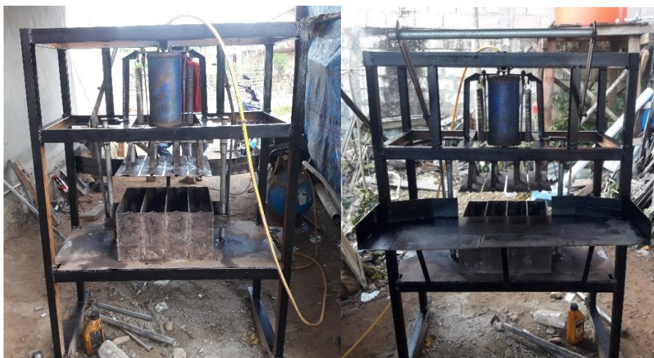
Gambar. 2 Alat pencetak batako menggunakan tekanan pada compressor
