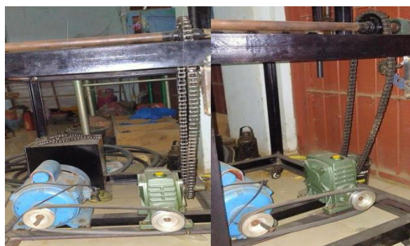
Gambar 3. Sistem transmisi hasil rancangan mesin pengrol
