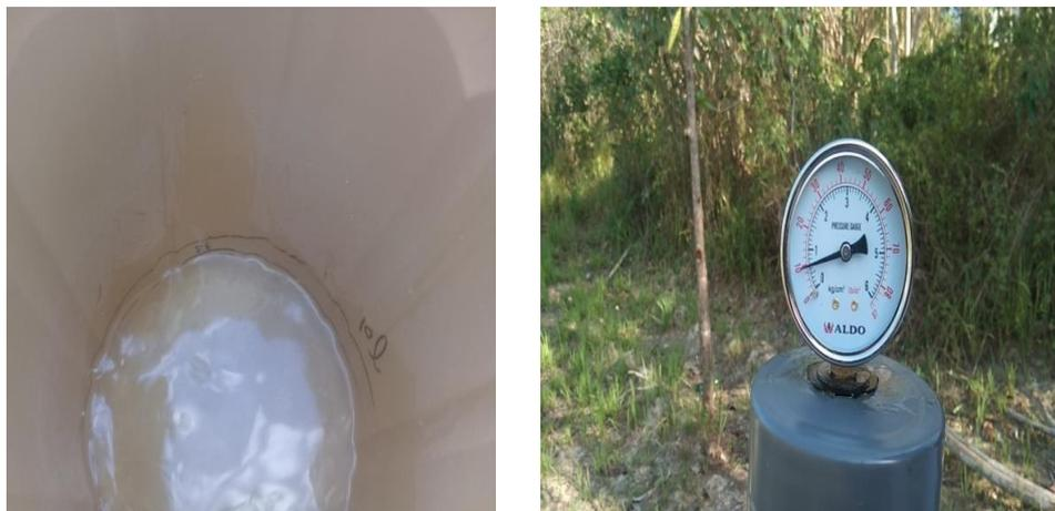
**Gambar 3.** Pengujian de4bit aliran dan tekanan air pompa
