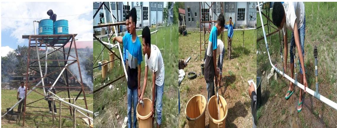
**Gambar 2.** Perakitan komponen utama pompa hidram dan pengujian kinerja pompa di lapangan
