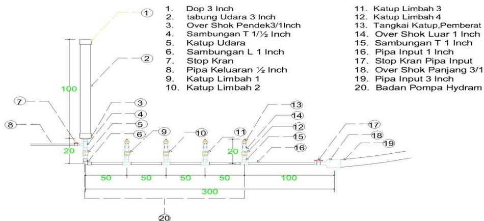
**Gambar 1.** Layout perancangan pompa hidram
