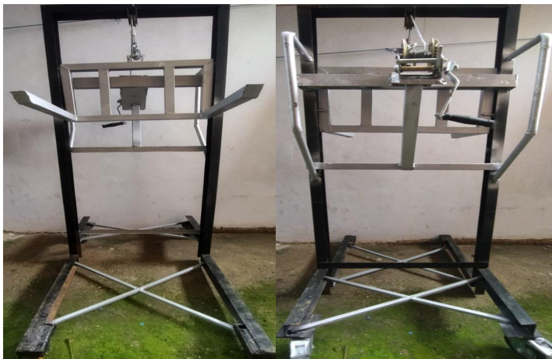
Gambar 3. Hasil rancangan forklift kapasitas 100 kg
