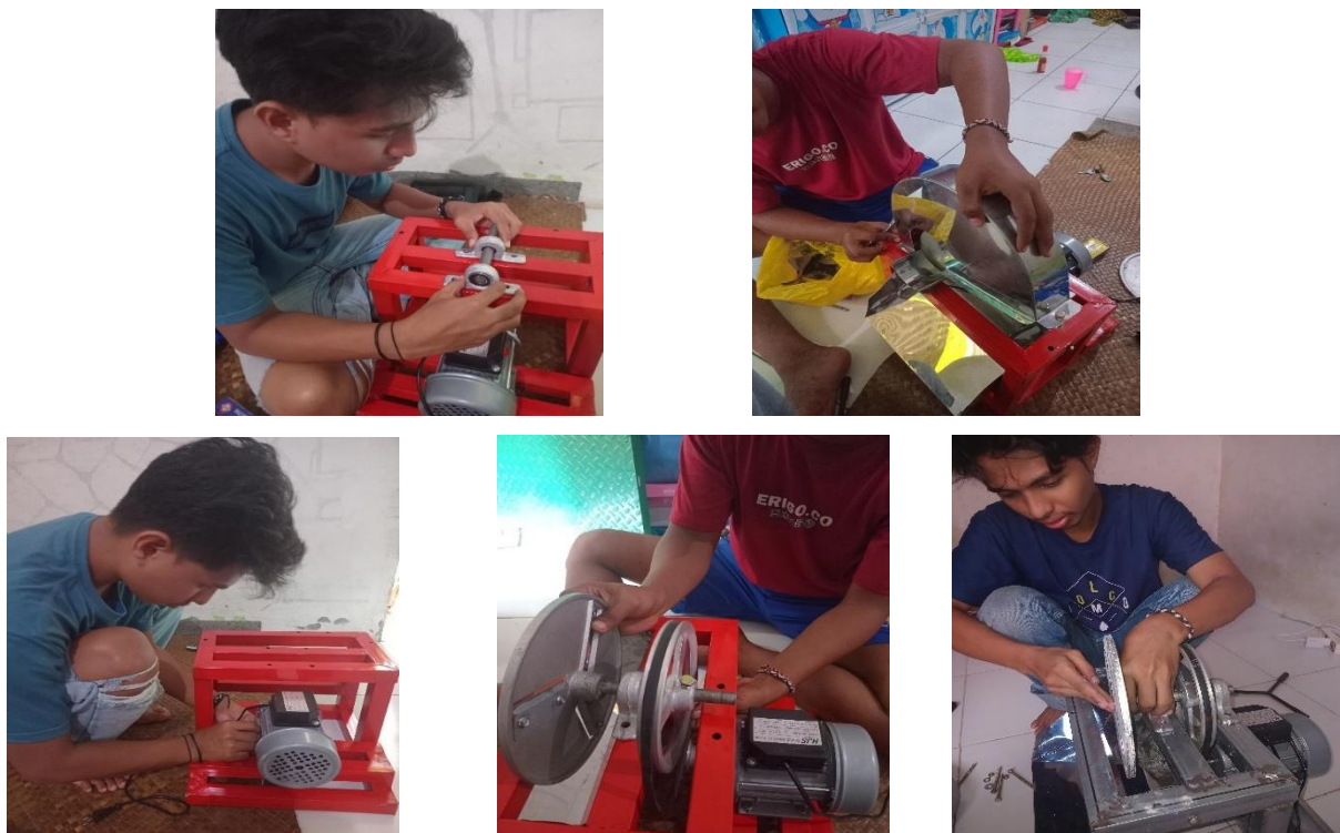
Gambar 12. Proses Perakitan Alat Perajang Singkong
