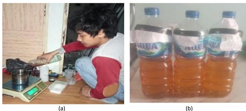
**Gambar 1.** (a) Proses penimbangan minyak goreng bekas; (b) Biodiesel hasil transesterifikasi (B40, B60, dan B80)
